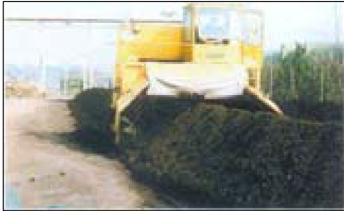
Figura 15: Sistem de compostare cu grămezi cu întoarcere
